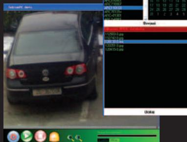
Za podešavanje parametara sustava koriste se standardni programi za serijsku komunikaciju (*HyperTerminal i sl.*) i RS232 sučelje izvedeno na kućištu same kamere. Za daljinski pristup uređaju u "aktivnom, konektiranom" stanju koristi se Windows TelcossPC korisnička aplikacija putem Internet pristupa.
